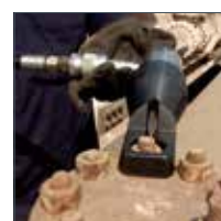
Mutternsprenger Modell YNS/YNS-AH, SW 11-89 mm
